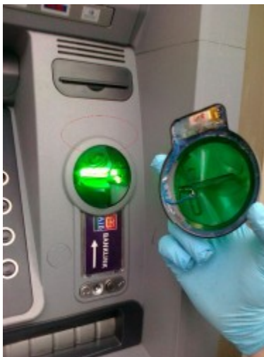
Rys.2. Zielony skimmer imitujący anti-simmerową nakładkę
